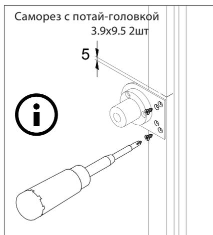
8\_ Установите адаптер и основание штанги - ролика на дверь
